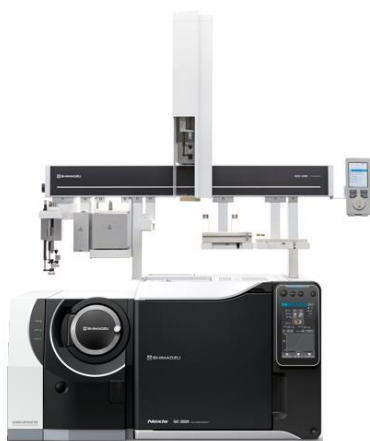
Figure 1 : Système Shimadzu combinant la SPME et l'analyse GCMS
